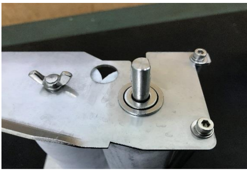
吸水スポンジ駆動歯車を外す。
