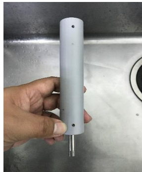
従動ローラーシャフトを引き抜く
