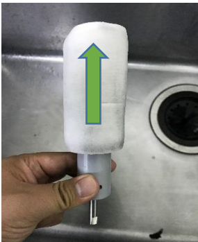
従動ローラーシャフトを引き抜く
