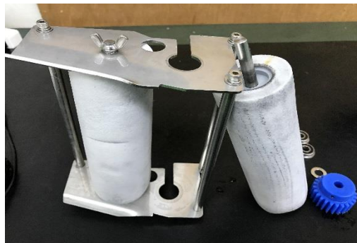
駆動ローラー取り外し完了
