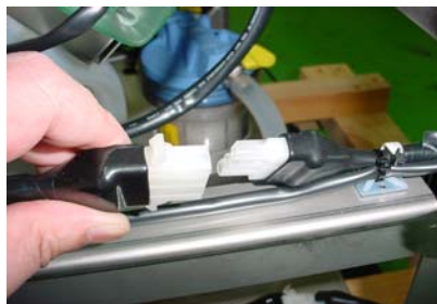
ホッパーのコネクター外しタンクを上に抜く
